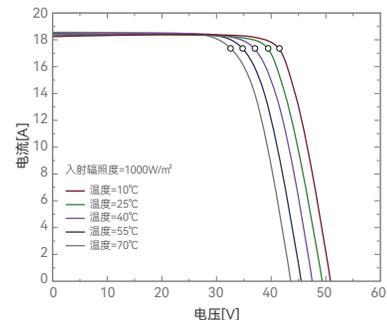
不同电池温度下电流-电压曲线图
